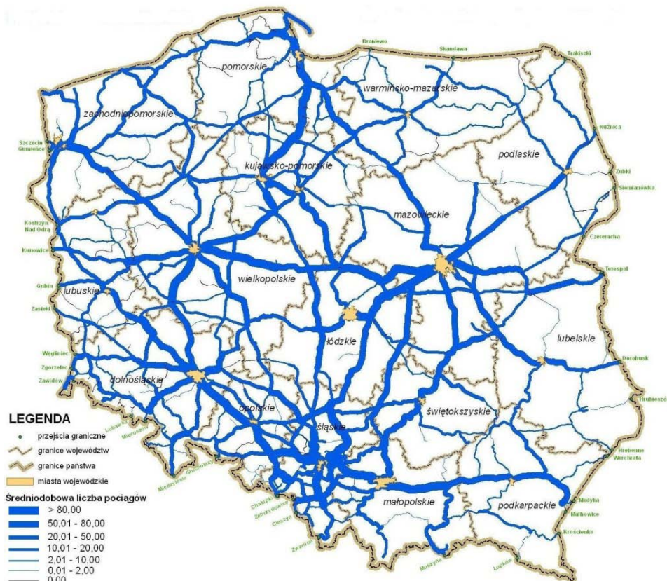
Rysunek 6 Średniodobowa liczba przejazdów pociągów na liniach zarządzanych przez PLK (razem pociągi pasażerskie i towarowe w obu kierunkach) – [szt.]
