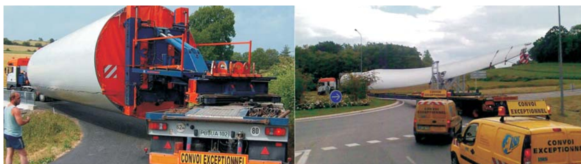
Fot. 6.5. Przewóz elementów siłowni wiatrowej na drogowych obiektach inżynierskich (źródło: http://www.universal-transport.pl/brane/elektrownie-wiatrowe/fahrzeugequipment.html )
