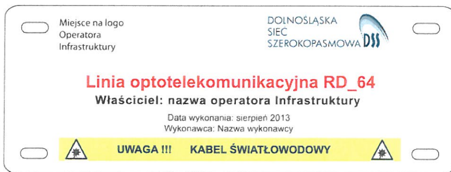
Rys. 9 Wzór graficzny zawieszki informacyjnej w Etapie zarządczym nr 2 o wymiarach 6 cm x 16 cm
